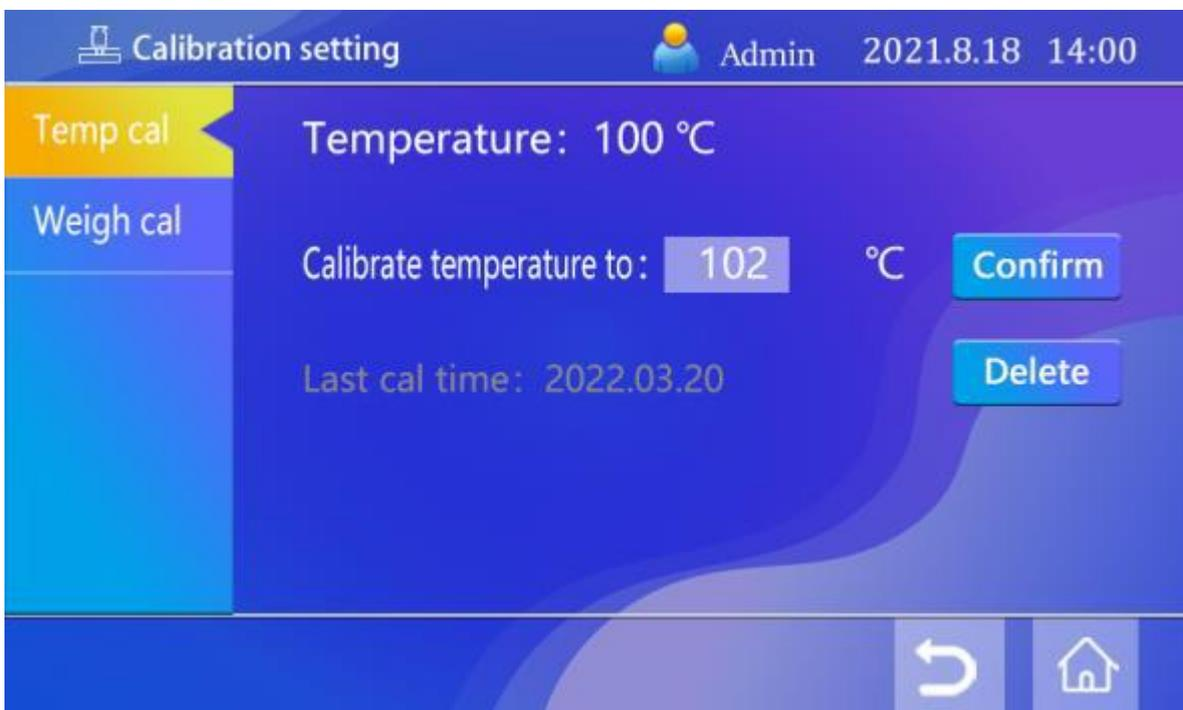
Erfahrungsgemäß ist eine Justierung des Temperatursensors so gut wie nie erforderlich, da die Ausgabe nur in 1°C Schritten erfolgt (180 Messschritte zwischen 0°C und 180 °C).
